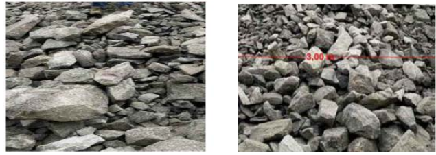
Рис. 3. Зображення розвалу відбитої вибухом гірничої маси на різних ділянках уступу кар'єру
